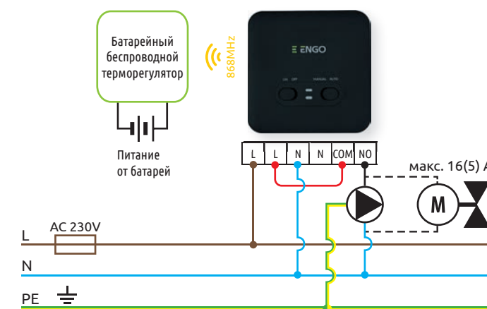
б) Схема подключения приёмника к насосу/сервоприводу
