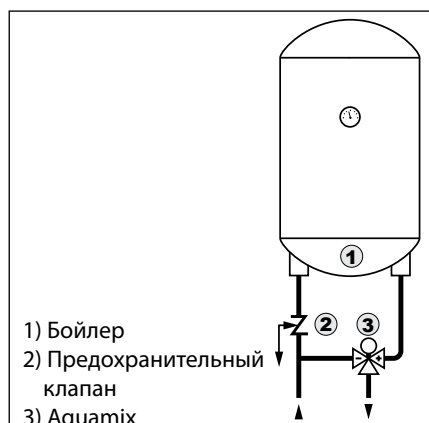
Система бытового ГВС
